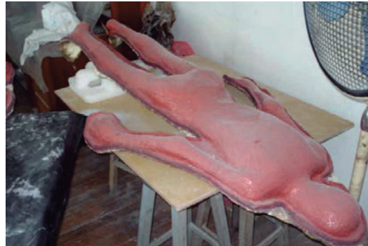
Figura 11a. Molde Definitivo en silicona de alta resistencia. Cuerpo Humano cara posterior.
